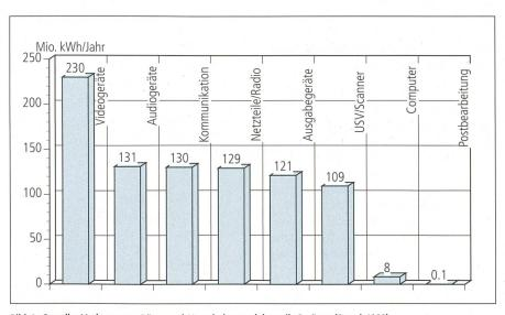
Bild 1 Standby-Verluste von Büro- und Unterhaltungselektronik-Geräten (Stand 1990).
