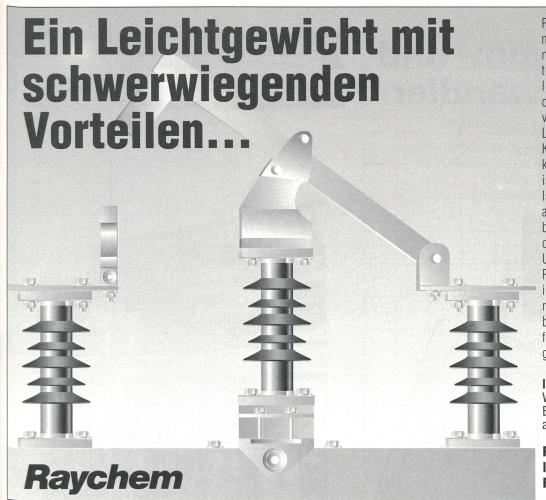
PolyLite Isolatoren aus Polymermaterial für Mittelspannungs-Freileitungsschalter bieten Ihnen die Vorteile einer leichtgewichtigen Bauweise. ohne Zugeständnisse an Zuverlässigkeit, Sicherheit oder Langlebigkeit. Der hochstabile Kern enthält keine feuchtigkeitsanfälligen Glasfasern und ist von einem Raysulate 200S-Isolationsmantel rundum dicht abgeschlossen. Diese Isolation besteht aus wasserabstossendem, kriechstromfestem und UV-resistentem Material.
