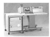
Steuerung für Prüfung mit Stossspannungs-Generatoren
