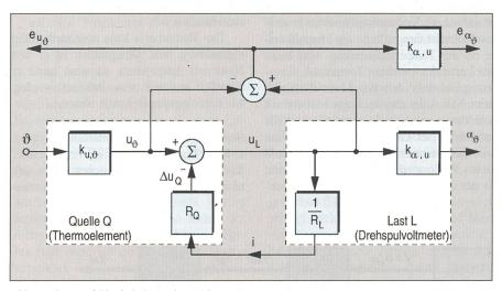
**Bild 8 Belastungsfehler bei einem Thermoelement**Zu hoher Quellwiderstand, zu niedriger Eingangswiderstand
