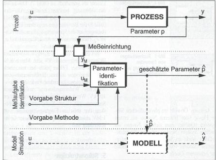
Bild 2 Parameteridentifikation als Messaufgabe Signalwirkbild
