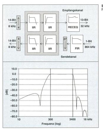
Bild 8 Digitalfilter mit Frequenzcharakteristik
