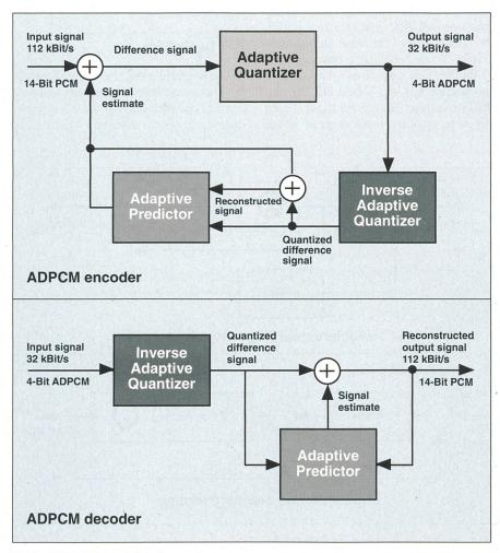
Bild 9 ADPCM-Koder und -Dekoder
