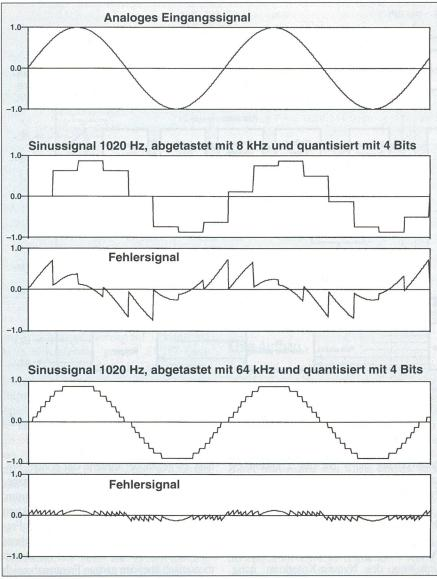
Bild 4 Darstellung des Oversampling im Zeitbereich
