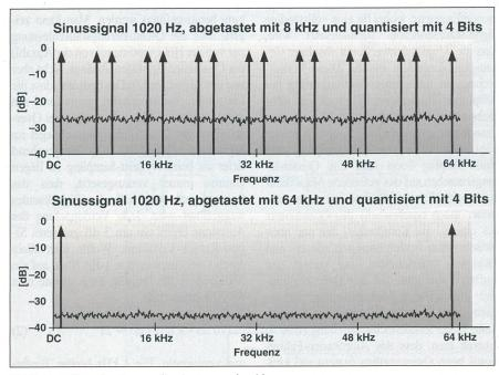
Bild 5 Darstellung des Oversampling im Frequenzbereich
