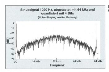
Bild 6 Noise-Shaping im Frequenzbereich
