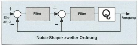
**Bild 7 Schematische Darstellung des Noise-Shapers** Q Rauschquelle
