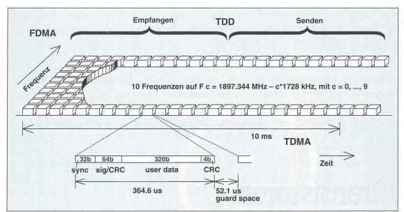
Bild 1 Dect-Rahmen-Struktur und Frequenzen
