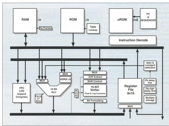
Bild 10 Realisierung der G.721-Transkoderzelle
