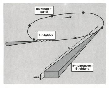
Synchrotronstrahlung: Elektronen, die in einem Speicherring mit hoher Geschwindigkeit zirkulieren, senden eine sehr intensive, stark nach vorn gebündelte elektromagnetische Strahlung aus (Bild PSI)
