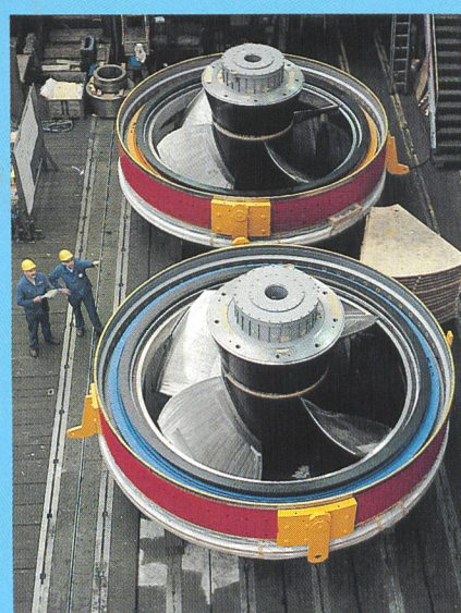
Die Straflo-Lauffräder Nr.1 für Augst und Wyhlen sind transportbereit. Vor Ort werden die von ABB gefertigten Generatorpole auf dem Laufradkranz befestigt (Juni 1992).
