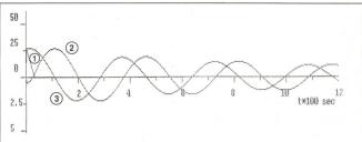
Ausdruck einer berechneten Kurve für eine Lastreduktion von 34% in der Zeit von 40 s (Entlastung zu Bild 2). Es bedeuten wie in Bild 2:
