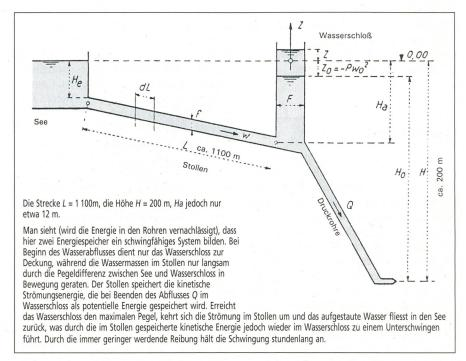
Bild 1 Prinzipdarstellung des hydraulischen Systems (aus Gründen der Übersicht nicht massstäblich dargestellt)
