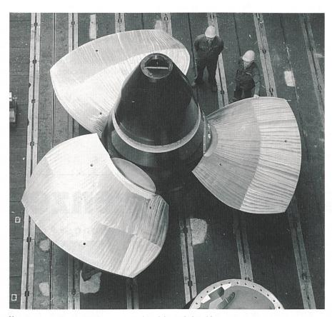
Photo 5 La première roue Kaplan pour Le Seujet a été montée à Zurich Bild 5 Abgeschlossene Werkmontage des ersten Kaplanlaufrades für «Le Seujet» in Zürich
