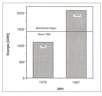
Bild 7 Zufluss zu NOK Speicherseen in produzierbarer Energie bzw. in Anteilen am Speichervermögen. Die mittleren Zuflussmengen der Monate Mai bis September von 1967 bis 1992 überstiegen das Speichervolumen um 14%
