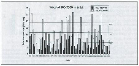
Bild 1 Langjährige in der Schneedecke gespeicherte Wasserreserven im Wägital am 1. April, getrennt nach unterem und oberem Teil des Einzugsgebietes. Der Mittelwert (m) beträgt 16,3 Mio m³ und die Standardabweichung (s) 7,5 Mio m³. Man beachte die grossen Jahr-zu-Jahr-Schwankungen der in der Schneedecke gespeicherten Wasservorräte, die bis zum Faktor 8 reichen können! (nach Lepori, 1992; leicht verändert)
