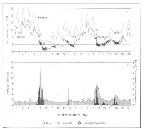
Bild 6 Lufttemperatur (a) der automatischen SMA-Stationen Gütsch (2282 m ü. M) und Disentis (1190 m ü. M.) mit den Symbolen der beobachteten Niederschlagsaggregate sowie Niederschlagsmenge (b) (Mittel der automatischen SMA-Stationen Disentis und Piotta, 1007 m ü. M.) und Abfluss des Somvixerrheins bei Encardens für den 1.–20. September 1984 (nach Angaben der Landeshydrologie und -Geologie). Die Graphik zeigt auf, wie wichtig die richtige Erfassung und Prognose der Niederschlagsform ist
