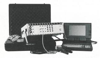
Das computer-unterstützte Mess-System EDA-33 eröffnet neue Perspektiven für die Erstellung von Stromsparanalysen. Dank seinen 33 Messkanälen und seiner Flexibilität können auch komplexe Verteilstrukturen aufgenommen und ausgewertet werden, wobei die Messwerte online am Bildschirm verfolgt werden können. Das modular aufgebaute Messgerät arbeitet mit einem Personal Computer zusammen, der den Messvorgang steuert und
