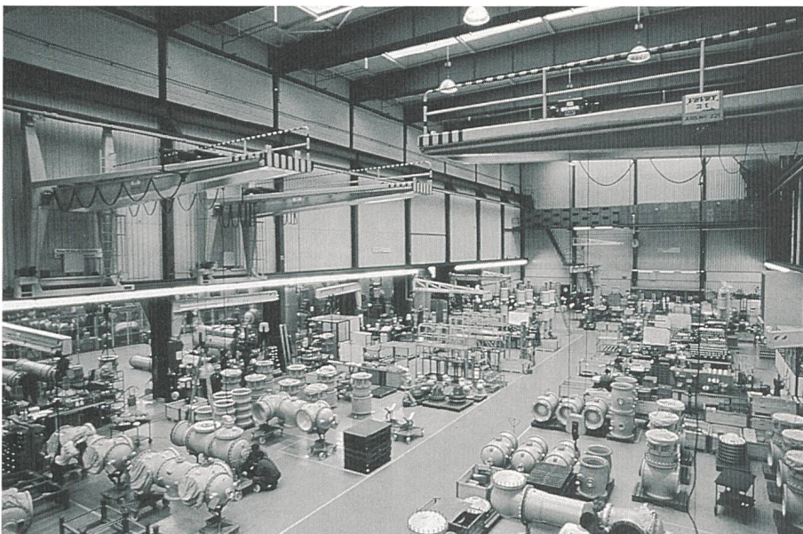
Bild 7 Montage einer gasisolierten Schaltanlage
