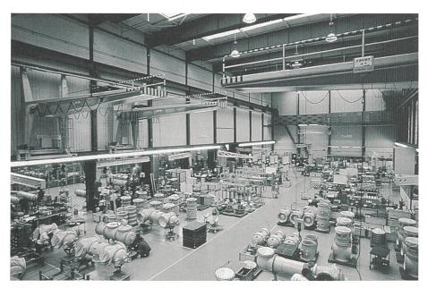
Bild 7 Montage einer gasisolierten Schaltanlage
