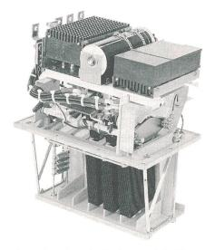
Bild 9 Phasenbaustein für ein Nahverkehrsfahrzeug mit Siederohr(«Heatpipe»)-Kühlung
