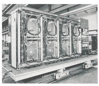
Bild 6 Stromrichteranlage für ein Drehgestell der Lok Re 460 der SBB
