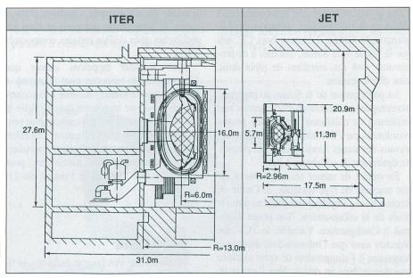
Figure 13 Comparaison des sections de JET et d'Iter
