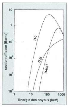
Figure 2 Sections efficaces de réactions de fusion
