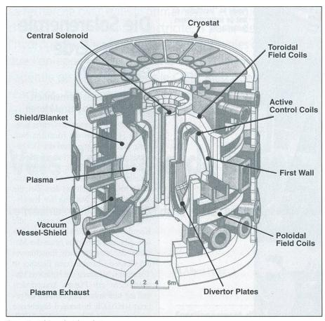
Figure 12 Schéma du tokamak Iter
