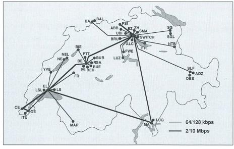
Bild 6 Die Topologie des Datennetzes Switch-LAN
