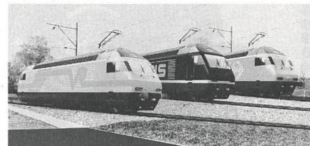
**33 In der Typenfamilie «Lok 2000» wird die neueste Drehstrom-Antriebstechnik mit Hochleistungs-GTO-Thyristoren konsequent eingesetzt**
