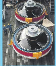
Die Straflo-Laufräder Nr.1 für Augst und Wyhlen sind transportbereit. Vor Ort werden die von ABB gefertigten Generatorpole auf dem Laufradkranz befestigt (Juni 1992).
