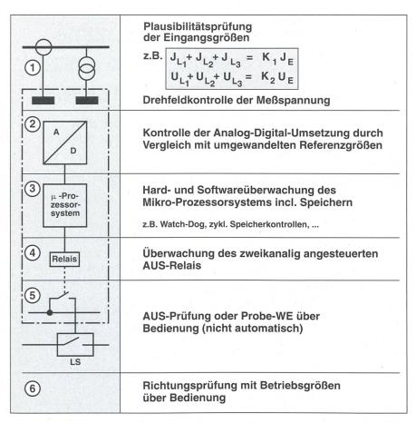
Bild 3 Überwachungskonzept eines digitalen Abzweigschutzgerätes
