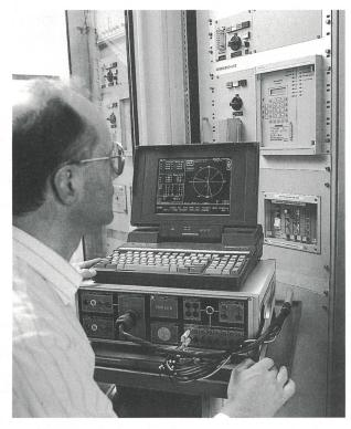
Vor-Ort-Prüfen von Distanzrelais: Individuelles Einstellen aller Spannungen und Ströme, Vorgeben von Fehlerimpedanzen in der Impedanzebene, Aufnehmen von Staffelplänen und Anregekennlinien, Ausgeben transienter Signale (NEU!), ...
