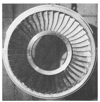
Die Wirksamkeit von Endstufen mit gebogenen Leitschaufeln wurde an dieser Modellturbine mit 10-m²-Endstufe untersucht
