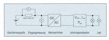
Bild 1 Prinzipschema des Messaufbaus
