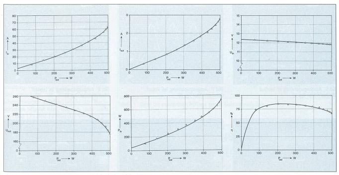
Bild 4 Messresultate zum Wechselrichter Typ C bei leicht abfallender Eingangsspannung  $U_{in}$
