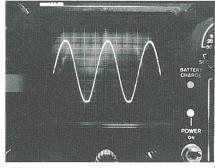
Bild 7 Ausgangsspannung bei Vollast (Wechselrichter Typ A)
