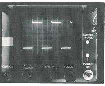
Bild 10 Ausgangsspannung im Leerlauf (Wechselrichter Typ C)
