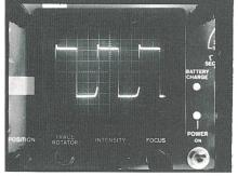
Bild 11 Ausgangsspannung bei Vollast (Wechselrichter Typ C)
