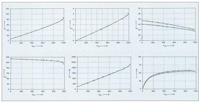
Bild 2 Messresultate zum Wechselrichter Typ A bei zwei leicht unterschiedlichen Eingangsspannungen U<sub>inr</sub> die mit P<sub>out</sub> leicht abfallen
