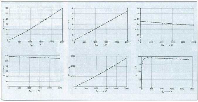
Bild 5 Messresultate zum Wechselrichter Typ D bei leicht abfallender Eingangsspannung  $U_{in}$
