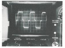
Bild 14 Ausgangsspannung bei Vollast (Wechselrichter Typ D)
