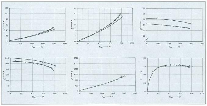
Bild 3 Messresultate zum Wechselrichter Typ B bei zwei leicht unterschiedlichen Eingangsspannungen  $U_{in}$ , die mit  $P_{out}$  leicht abfallen
