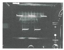
Bild 8 Ausgangsspannung im Leerlauf (Wechselrichter Typ B)
