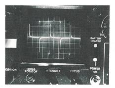
Bild 12 Ausgangsspannung im Leerlauf (Wechselrichter Typ D)
