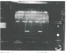
Bild 13 Ausgangsspannung bei Teillast (Wechselrichter Typ D)
