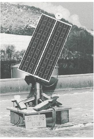
Bild 2 Sonnennachgeführte Solarmodule (Arco M55) in der Photovoltaik-Messanlage am PSI. Die beiden Module werden mit einer automatischen Steuerung permanent auf die Sonne ausgerichtet. Im Gegensatz zu den fixmontierten Modulen in Bild 1 konnten hier bis anhin keine produktionsmindernden Schneeablagerungen beobachtet werden. Oben an den Modulen ist das Solarimeter zur Erfassung der globalen Einstrahlung in die Zellenebene montiert
