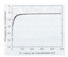
Bild 5 Wechselrichter-Wirkungsgrad (Messwerte vom März 1993)
