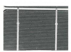
Bild 2 Durch Stossströme in der Montagestruktur beschädigte Solarzelle
