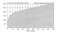
Bild 2 Kumulierte Nennleistung der erfassten Solarzellenanlagen. Für diese Graphik wurden die Nennleistungen aller bekannten Anlagen der Grösse nach geordnet und in Funktion der Anzahl Anlagen kumuliert. Die Graphik zeigt auf, dass die grössten 25 Anlagen bereits knapp die Hälfte der Nennleistung aller 456 Anlagen aufweisen. Ungefähr ab der hundertsten Anlage verläuft die Kurve flach. In diesen Bereich fallen alle Anlagen zwischen 3–4 kW<sub>p</sub>, die anzahlmässig am stärksten vertreten sind
