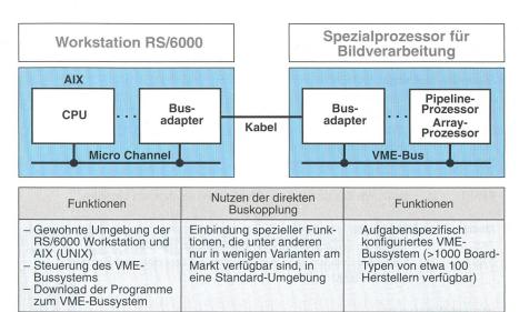
Bild 8.1 Beispiel 1: Workstation mit Spezialprozessor für Bildverarbeitung
