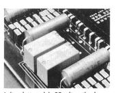
Leiterplattenrelais RE mit optimaler Bauhöhe
