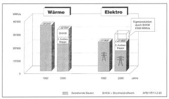
Energiebilanzen für die ETH Hönggerberg 1992/2000 (nach Ausbau der 3. Etappe unter Berücksichtigung von Sanierungsmassnahmen)
