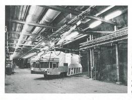
Schon seit 1988 in Betrieb: Endlager in Forsmark (Schweden), hier wird ein Abfallcontainer in die Endlagerzone gebracht
