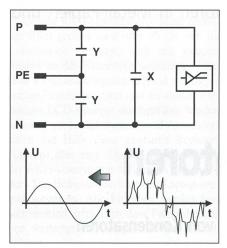
Bild 1 Funkentstör-Kondensatoren
