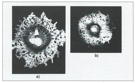
Bild 3 Ausheilprozess von Kondensatoren
