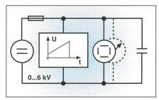
Bild 4 Prüfkreis für Gleichspannungstest
