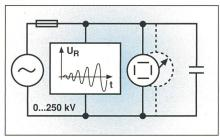
Bild 5 Prüfkreis für AC-Test
