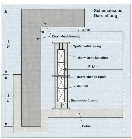
Bild 5 900-MJ-Smes mit Streufeldabschirmung
