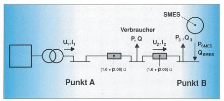
Bild 1 Topologie und Daten des Leitungsabschnittes
