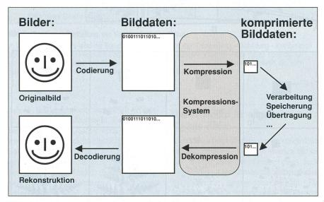
Bild 1 Schema eines Datenkompressionssystems in der Bildverarbeitung
