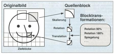
Bild 7 Schema des Kompressionsvorganges
