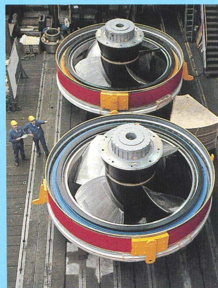
Die Straflo-Laufräder Nr.1 für Augst und Wyhlen sind transportbereit. Vor Ort werden die von ABB gefertigten Generatorpole auf dem Laufradkranz befestigt (Juni 1992).
