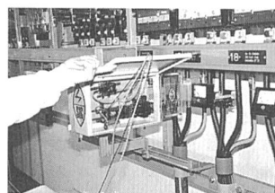
Ampèremètre à fibre optique fonctionnant dans un environnement perturbé
