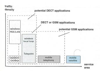
Figure 7 Domaines d'application des divers systèmes radio
