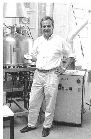
Projektleiter Roland Diethelm mit einer «Hexis»-Brennstoffzelle vor einem elektrochemischen Prüfstand, wo Langzeitversuche bei 900 °C durchgeführt werden
