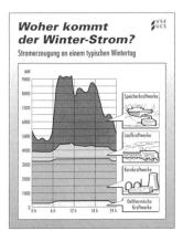
ihrer gleichmässigen Leistung ein genügendes Fundament liefern, indem sie die «Grundlast» an Strom abdecken, die rund um die Uhr gebraucht wird.
