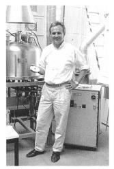
Projektleiter Roland Diethelm mit einer «Hexis»-Brennstoffzelle vor einem elektrochemischen Prüfstand, wo Langzeitversuche bei 900 ℃ durchgeführt werden
