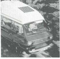
Bild 8 Anwendungsbeispiele von flexiblen Modulen
