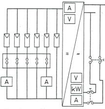
Bild 7 Schema zu Bild 6: Netzrückspeisung
