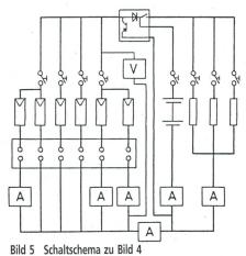
Das Schema ist als batteriegepufferte Ladestation für Elektro-Gabelstapler konzipiert
