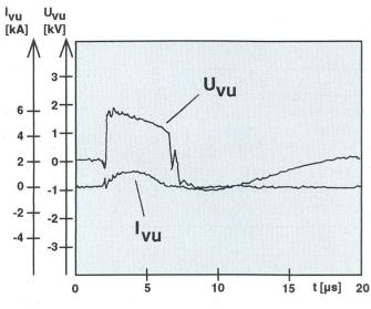
Bild 16 Strom und Spannung am PV-Modulseitigen Überspannungsableiter
