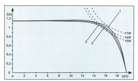
Bild 10 Kennlinien eines Moduls mit Rahmen
