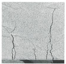
Bild 14 Schäden am Rückseitenkontakt einer polykristallinen Solarzelle
