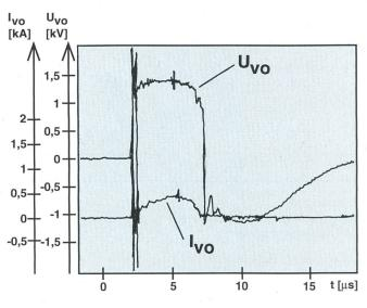
Bild 17 Strom und Spannung am wechselrichterseitigen Überspannungsableiter
