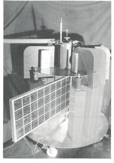
Bild 3 Fotografie des Stossstromgenerators der ISB mit zu Testzwecken montiertem Solarmodul
