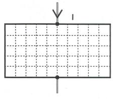
Bild 8 Strossstrom-Einspeisung bei PV-Modul mit Rahmen
