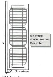
**Bild 7 Testanordnung**Anordnung zum Test von dreizelligen Mini-Solarmodulen (aus [7])
