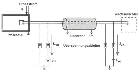
Bild 15 Schema des verwendeten Modells einer Photovoltaikanlage
