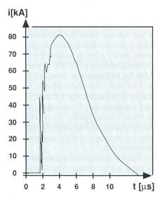
Bild 5 Stossstrom der ISB-Anlage Typischer, mit der ISB-Anlage erzeugter Stossstrom [7]: I<sub>max</sub> = 80 kA, di/dt = 53 kA/µs
