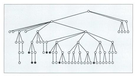
Bild 2 Typischer Suchbaum für eine Netzoptimierung Jeder Kreis symbolisiert einen erlaubten Netzzustand
