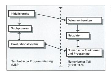
Bild 3 Hybrider Aufbau eines Expertensystems
