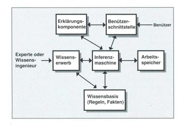
Bild 1 Grundstruktur eines Expertensystems
