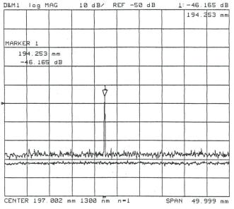
Bild 6 Messung des RL mit einem Michelson-Interferometer
