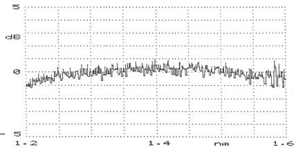
Bild 8 Kopplungsverhältnis eines WIC (1x2) in Funktion der Wellenlänge, gemessen mit einer Weisslichtquelle
