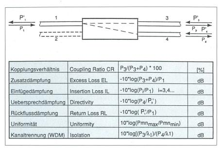
Bild 2 Definitionen der Kopplerparameter bei einem 1x2- und 2x2-Koppler
