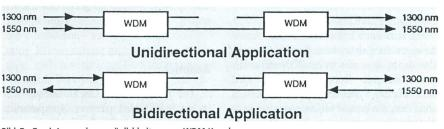
Bild 7 Zwei Anwendungsmöglichkeiten von WDM-Kopplern
