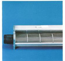
Querstromgebläse Bis 3'000 m³/h, Walzendurchmesser 60/80/100/120 mm und Längen bis 1200 mm, 90° oder 180° durchströmt, auch als 19''-Einheit.
