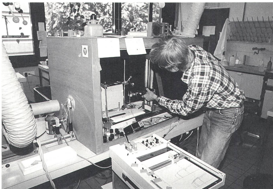
Figure 2 Andreas Kray, collaborateur de Grätzel, prépare la mesure de rendement d'une cellule expérimentale: à gauche la source de lumière, dans l'armoire l'optique de mesure, devant l'enregistreur
