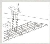
Kleine Gitterbahnen, schraubenlos befestigt
