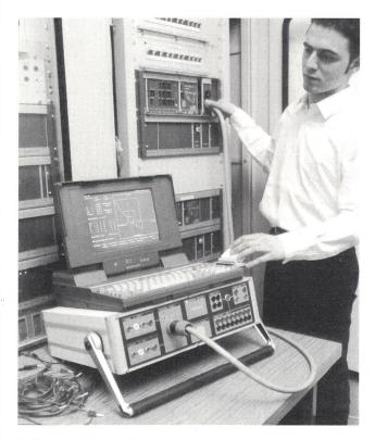
Prüfen von Distanzrelais am Einbauort: Individuelles Einstellen aller Generatorgrößen, Vorgeben von Fehlerimpedanzen in der Impedanzebene, automatisches Aufnehmen von Staffelplänen und Anregekennlinien, ...
