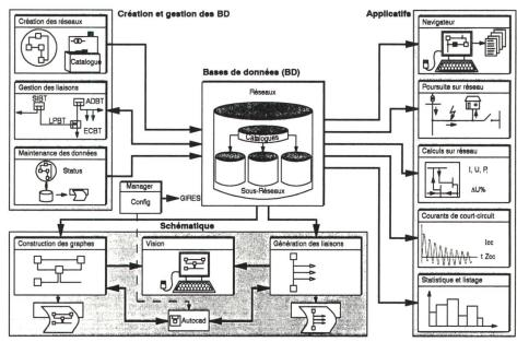
Figure 3 L'architecture du logiciel Gires
