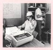
doch zusätzliche Mühen und Kosten verursachen würden, also zum Beispiel in Ausstellungen, auf Baustellen usw. Ascomfax 260 ist standardmässig mit einer Schneidevorrichtung und mit Vorlageneinzug für 30 Blätter, Ziel- und Kurzwahlmöglichkeit ausgerüstet und arbeitet mit Thermopapier (100 m-Rollen). Durch sein integriertes Natel C ist es zusätzlich auch als Telefonapparat zu verwenden.
