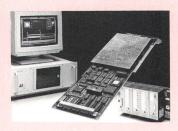
hältlich sein. Die Slot-PLC lässt sich in sämtlichen Sicomp Industrie-PCs neueren Datums stekken (PC 32-20, PC 32-C, PC 32-H, PC 32-M, PC 32-P, PC 32-R), ältere Geräte können in der Regel nachgerüstet werden.
