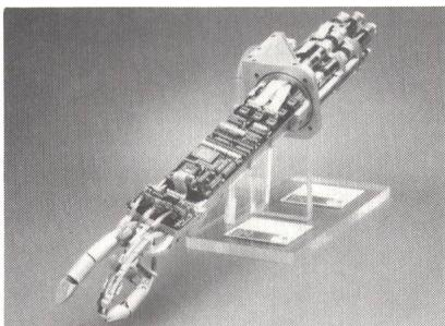
Die Entwicklung eines integrierten, menschenähnlichen Hand-Arm-Systems ist das Ziel einer Forschergruppe an der Universität Bologna. Insgesamt 18 Antriebsmotoren und Linearumsetzer treiben den auf der Titelseite gezeigten Prototypen an.
