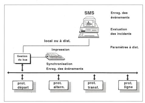
Figure 1 Système de surveillance et d'évaluation (SMS)
