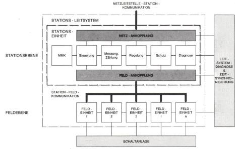
Bild 2 Struktur Stationsleittechnik
