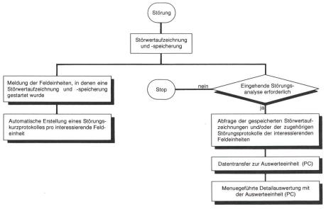
Bild 4 Störungsauswertung und Informationsbereitstellungs-Flussdiagramm
