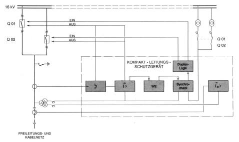
Bild 3 Vergleich Einzelschutzrelais mit Kompaktleitungsschutzgerät als Leitungsschutz
