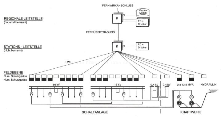
Bild 5 Integriertes Leitsystem für Wasserkraftwerk mit Schaltanlage
