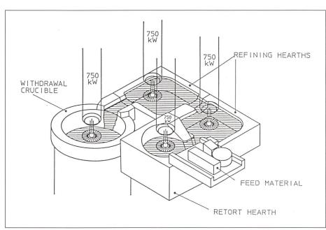
Bild 2 – Plasma<br/>ofen von Teledyne Allvac für die Herstellung von Titanlegierungen mit vier Plasmastrahlen von <br/>je 750 kW
