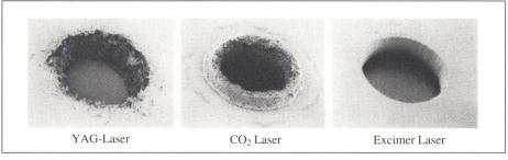
Bild 3 Laserverfahren im Vergleich
