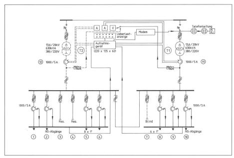
Bild 3 Anschlussschema der Trafostation
