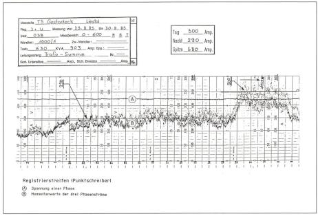
Bild 1 Strommessungen mit elektromechanischem Registrierinstrument Aufzeichnung der Momentanwerte
