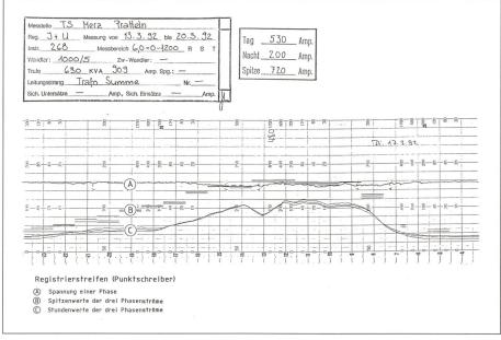
Bild 2 Strommessungen mit elektromechanischem Registrierinstrument Aufzeichnung der Stundenwerte
