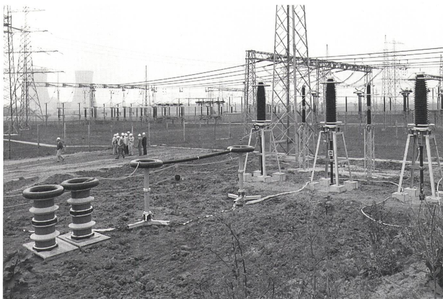
Bild 5 Vor-Ort-Wechselspannungsprüfung einer 220-kV-VPE-Kabelanlage
