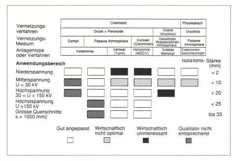
Bild 5 Herstellung von Kabelisolationen Vergleich heute verwendeter Verfahren für die Herstellung vernetzter Kabelisolationen
