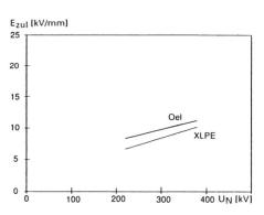
Bild 1 Spannungsgradienten in Kabelisolationen
