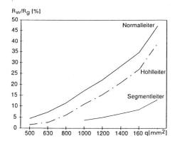
Bild 3 Wechselstromwiderstand von Kabelleitern
