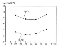
Bild 8 Dielektrischer Verlustfaktor von VLPE- und PPLP-Isolationen
