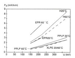
Bild 2 Dielektrische Verluste in Kabelisolationen
