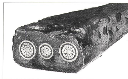
Bild 1 Papierbleikabel älterer Technologie Die drei Einleiter Papierbleikabel, verlegt in mit Bitumen ausgegossenem Blechkanal, waren in Betrieb seit der Jahrhundertwende bis Mitte der 70er Jahre
