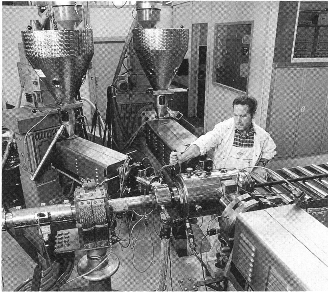
Bild 7 Kontaktrohr- vernetzungsanlage Ansicht mit Extrudern und Dreifachspritzkopf
